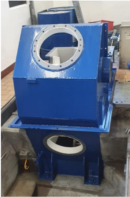
Turbinenkasten fertig beschichtet
